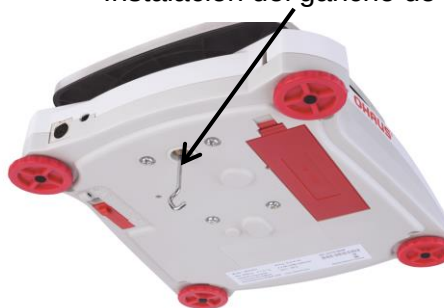
Instalación del gancho de pesaje inferior
